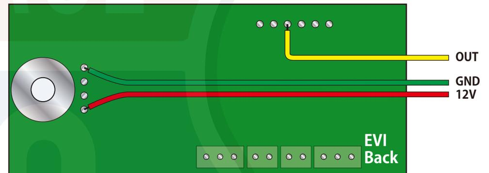
EWI と EVI は電源コネクタと出力コネクタが向きが逆になっています、必ず色を確認してから接続して下さい。
